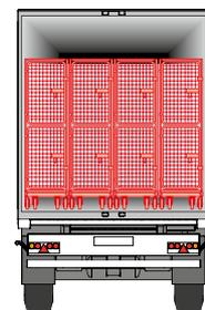
**Serienmäßige Ausstattung:** Untergestell aus Vierkantrohrrahmen, gebogen. Klappbare Auflagefläche aus Flachstahlrahmen mit Draht, verstärkt mit Flachstahlunterzügen. Containeraufbau aus Rundrohrrahmen mit Drahtmaschung und Kunststoffscharnieren. Öffnungswinkel der Tür 270°.
