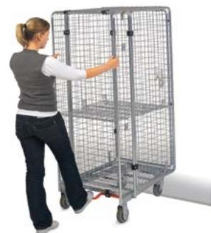
**Serienmäßige Ausstattung:** Untergestell aus Vierkantrohrrahmen, gebogen. Klappbare Auflagefläche aus Flachstahlrahmen mit Draht, verstärkt mit Flachstahlunterzügen. Containeraufbau aus Rundrohrrahmen mit Drahtmaschung und Kunststoffscharnieren. Öffnungswinkel der Tür 270°.
