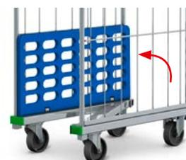
**Serienmäßige Ausstattung:** Z-förmiges Untergestell aus Vierkantrohrrahmen mit Profil-Abschlusskappen in Grün (vorn) und Rot (hinten). Zwei Seitenteile aus Rundrohrrahmen mit Drahtmaschung. Abklappbare Bodenplatte aus Blech oder Kunststoff in RAL 5005 Signalblau. Inkl. 2 Textilspanngurte.
