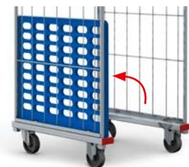
**Serienmäßige Ausstattung:** Z-förmiges Untergestell aus Vierkantrohrrahmen mit Profil-Abschlusskappen in Grün (vorn) und Rot (hinten). Zwei Seitenteile aus Rundrohrrahmen mit Drahtmaschung. Abklappbare Bodenplatte aus Blech oder Kunststoff in RAL 5005 Signalblau. Inkl. 2 Textilspanngurte.
