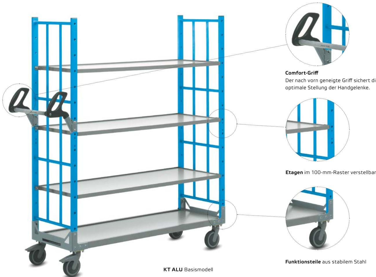
**Serienmäßige Ausstattung:** Seitenteile, Etagenrahmen und Untergestellrahmen aus Aluminium. 3 Etagen mit Plattform aus Alu-Kunststoff-Verbundwerkstoff, fest verschraubbar im 100-mm-Raster. Ergonomischer Comfort-Griff. Funktionsteile aus Stahl für optimale Stabilität.
